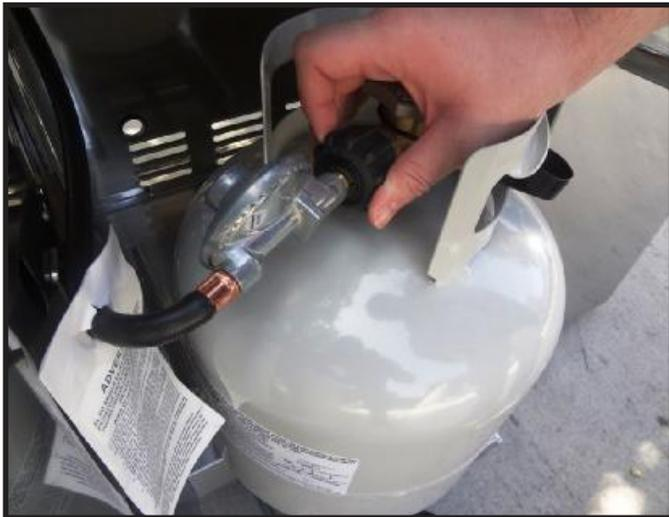
Remettez l'écrou d'accouplement du régulateur sur le réservoir de propane en le tournant dans le sens des aiguilles d'une montre. Lentement ouvrir le valve de gaz de réservoir de propane et continuer tourner la vanne très lentement dans le sens inverse des aiguilles d'une montre jusqu'à ce qu'il ne tourne plus.
