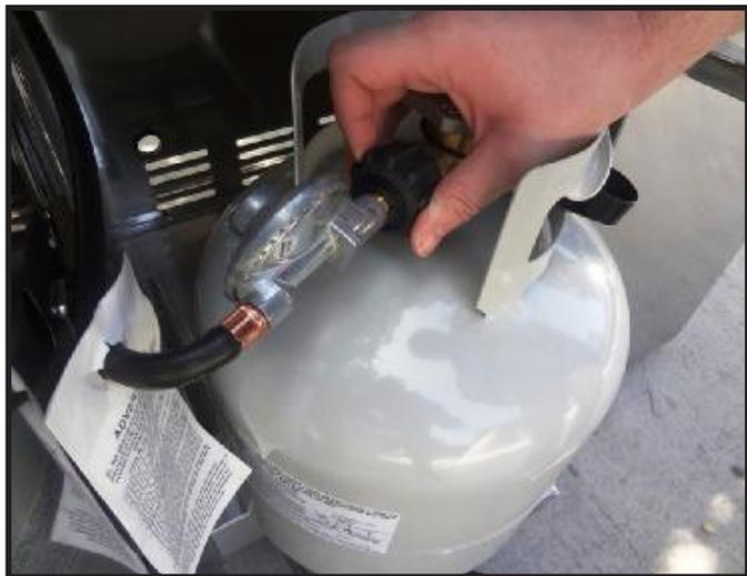
Retirer l'écrou d'accouplement du régulateur du réservoir de propane en tournant l'écrou d'accouplement dans le sens antihoraire.
