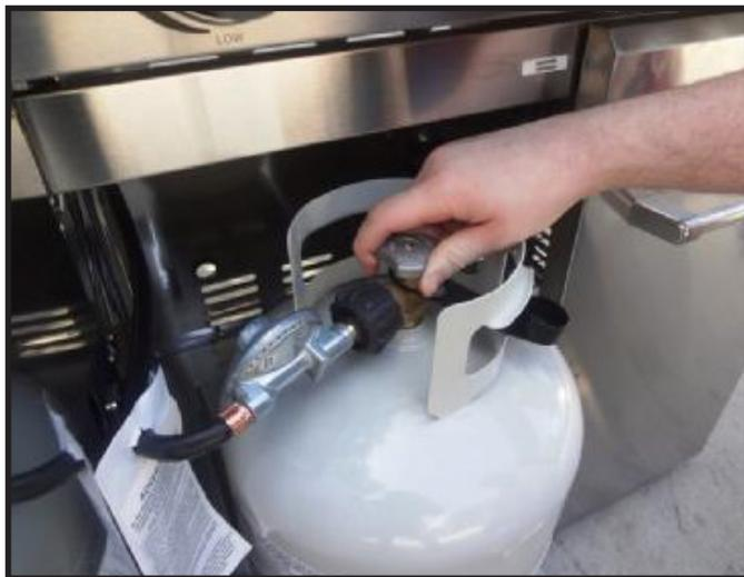
Tourner le robinet de gaz du réservoir de propane dans le sens des aiguilles d'une montre à la position d'arrêt.
