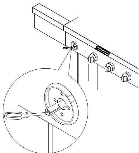
3. Verifique que el quemador funcione en el nuevo ajuste de llama alta. Tal vez sea necesario regular el ajuste del tornillo un poco más para obtener la altura ideal de la llama del quemador.
