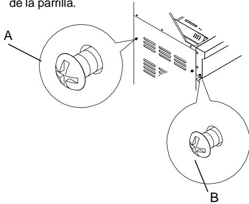
A. Tornillos del panel del lado del asador
