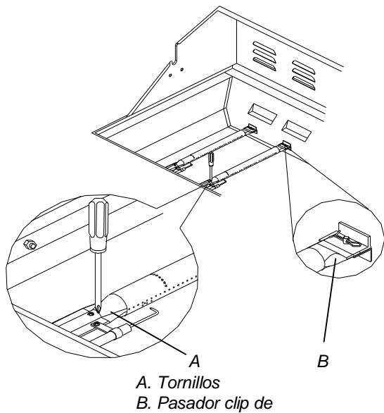
3. Inspeccione con una linterna el interior del quemador a través de la abertura, para cerciorarse de que no esté obstruido. Si se ve alguna obstrucción, use una percha de metal enderezada para desbloquearlo.
