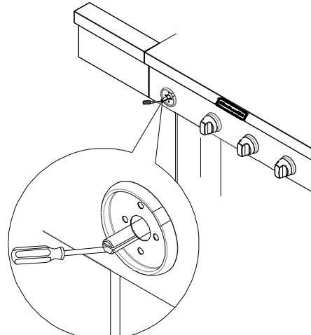
3. Vérifier que le brûleur fonctionne au nouveau réglage de flamme haute. Il sera peut-être nécessaire d'ajuster légèrement le réglage de la vis pour obtenir la hauteur de flamme de brûleur idéale.
