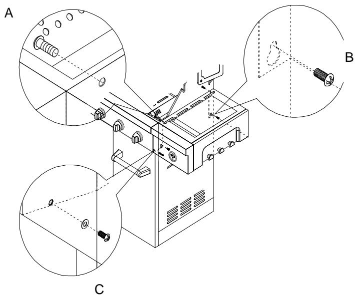
8. Quite los 2 tornillos del ensamblaje de la válvula del quemador lateral. Vea la ilustración del paso 10.
