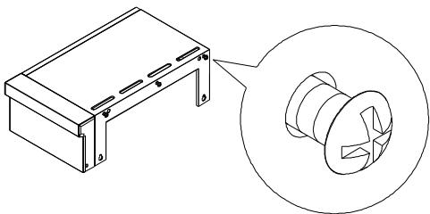
4. Desserrez les 2 vis sur le panneau latéral du gril sans les retirer complètement et retirez 1 vis sur le panneau de commande du gril.
