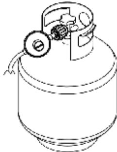
5. Visser à la main l'ensemble détendeur/tuyau dans le sens horaire pour le raccordement à la bouteille de propane de 20 lb, tel qu'indiqué.
