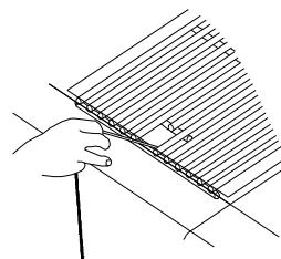
6. Empuje la perilla del quemador hacia dentro y gírela hacia IGNITE/HIGH (Encender/Alto) para el quemador que esté más cerca del cerillo encendido. El quemador se encenderá inmediatamente. Cuando el quemador esté encendido, gire la perilla hacia el ajuste deseado.
