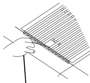
6. Pour le brûleur le plus proche de l'allumette allumée, enfoncez et faire tourner le bouton du brûleur à IGNITE/HIGH (allumage/élévé) ou IGNITE/ON (allumage/marche). Le brûleur s'allume immédiatement. Lorsque le brûleur est allumé, tourner le bouton jusqu'au réglage désiré.
