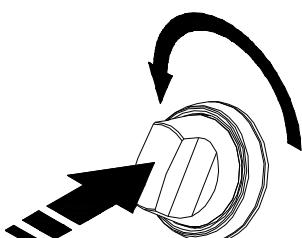
4. On doit pouvoir entendre le "crémitement" d'une étincelle. Lorsque le brûleur est allumé, lâcher le bouton. Tourner le bouton de commande au réglage désiré.
