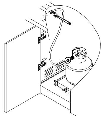
7. Utiliser une clé à molette pour installer le détendeur pour gaz naturel sur la tubulure de distribution et fixer. Fixer le détendeur pour gaz naturel au panneau latéral à l'intérieur du chariot du gril à l'aide des deux vis préassemblées sur le détendeur.
