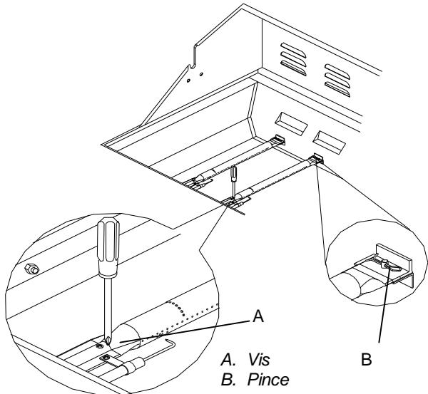
3. Utiliser une lampe de poche pour inspecter l'intérieur du brûleur par l'intermédiaire de l'entrée du brûleur pour vérifier qu'il n'y a pas de blocage. En cas d'obstruction, utiliser un cintre métallique redressé pour éliminer l'obstruction.
