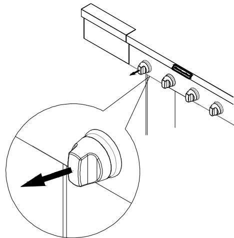
2. Utiliser un tournevis à lame plate pour tourner la vis de réglage de flamme haute dans le sens antihoraire d'environ 90° .
