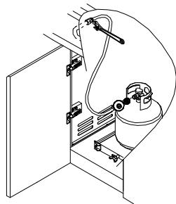
6. Use una llave de tuercas ajustable para instalar la manguera reguladora de gas natural al distribuidor y asegurarla. Sujete el regulador de gas natural al panel lateral, que está dentro del carro del asador, con los dos tornillos que están previamente ensamblados en el regulador.
