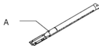
A. Tornillo de ajuste del obturador de aire
