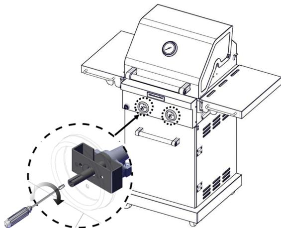
3. Vérifier que le brûleur fonctionne correctement avec le nouveau réglage de flamme haute. Il sera peut-être nécessaire d'ajuster légèrement le réglage de la vis pour obtenir la hauteur de flamme de brûleur idéale (1 pouce).
