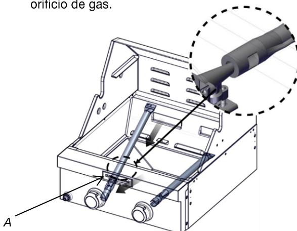
A. Conexión del quemador/orificio
