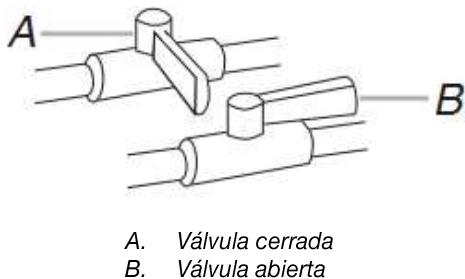
8. Pruebe todas las conexiones utilizando una solución de detección de fugas no corrosivo aprobado. Burbujas si hay fuga. Corregir cualquier fuga que encuentre.
