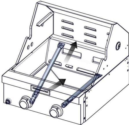
3. Inspeccione con una linterna el interior del quemador a través de la abertura, para cerciorarse de que no esté obstruido. Si se ve alguna obstrucción, use una percha de metal enderezada para desbloquearlo.
