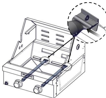
6. Coloque los equipos de encendido por lo que son de 1/8 "(3,2 mm) de cada quemador .
