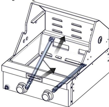
3. Utiliser une lampe de poche pour inspecter l'intérieur du brûleur par l'intermédiaire de l'entrée du brûleur pour vérifier qu'il n'y a pas de blocage. En cas d'obstruction, utiliser un cintre métallique redressé pour éliminer l'obstruction.
