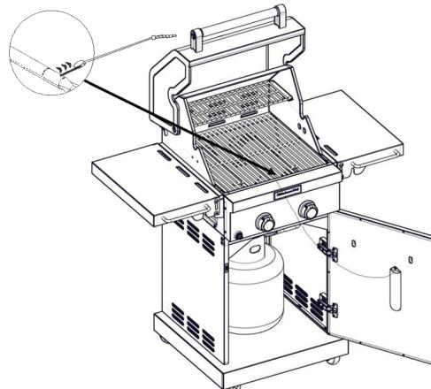
6. Pour le brûleur le plus proche de l'allumette allumée, enfoncez et faire tourner le bouton du brûleur à "gas" (allumage). Le brûleur s'allume immédiatement. Lorsque le brûleur est allumé, tourner le bouton jusqu'au réglage désiré.
