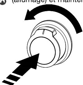
4. On doit pouvoir entendre le "crispement" d'une étincelle. Lorsque le brûleur est allumé, lâcher le bouton. Tourner le bouton de commande au réglage désiré.
