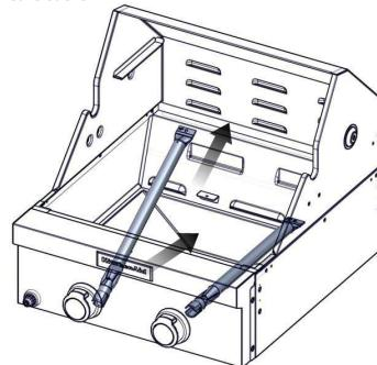
7. Si la llama está amarilla (no hay suficiente aire), gire hacia la izquierda el tornillo de ajuste del obturador de aire. Si la llama hace ruido o se separa del quemador (hay demasiado aire), gire hacia la derecha el tornillo de ajuste del obturador de aire.
