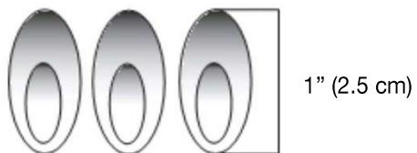
Vérifier que les brûleurs ne sont pas obstrués par de la poussière, des débris, nids d'insectes, etc.; nettoyer au besoin. Si les brûleurs sont propres, ajuster l'admission d'air au besoin.
