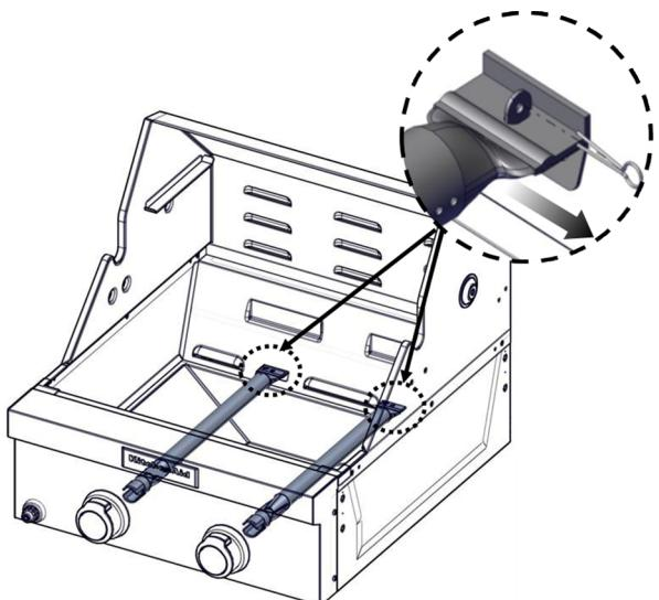
6. Desmontar el quemador de la parrilla levantando el quemador a cabo.
