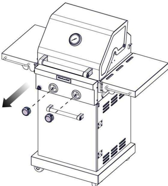
2. Use un destornillador de hoja plana para girar el tornillo opresor de llama alta hacia la izquierda aproximadamente 90° .
