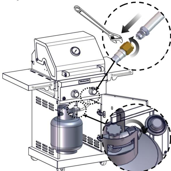
6. Use una llave de tuercas ajustable para instalar la manguera reguladora de gas natural al distribuidor y asegurarla. Sujete el regulador de gas natural al panel lateral, que está dentro del carro del asador, con los dos tornillos que están previamente ensamblados en el regulador.
