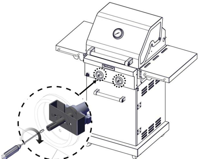
3. Verifique que el quemador funcione en el nuevo ajuste de llama alta. Tal vez sea necesario regular el ajuste del tornillo un poco más para obtener la altura ideal de la llama del quemador.
