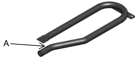
A. Vis de réglage de l'admission d'air
