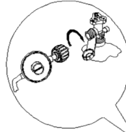
A. Ensamblaje de regulador de presión/manguera de gas B. Tanque de gas combustible LP de 20 lb
