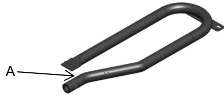
A. Vis de réglage de l'admission d'air
