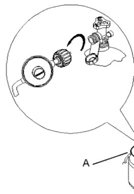
A. Ensamblaje de regulador de presión/manguera de gas B. Tanque de gas combustible LP de 20 lb
