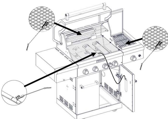
6. Empuje hacia dentro y gire la perilla del quemador hacia “●” (Encender) para el quemador que esté más cerca del cerillo encendido. El quemador se encenderá inmediatamente. Cuando el quemador esté encendido, gire la perilla hacia el ajuste deseado.
