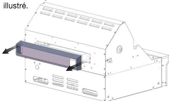
4. Retirer les deux vis du support de l'électrode pour retirer le support comme illustré.
