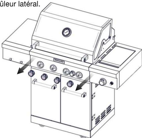
2. Utiliser un tournevis à lame plate pour tourner la vis de réglage de flamme haute dans le sens inverse des aiguilles d'une montre d'environ 90°.
