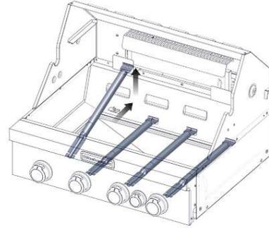
7. Si les flammes présentent une teinte jaune (pénurie d'air), faire tourner la vis de réglage de l'admission d'air dans le sens antihoraire. Si la combustion est bruyante ou si les flammes se séparent du brûleur (excès d'air), tourner la vis de réglage de l'admission d'air dans le sens horaire.
