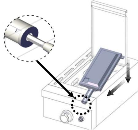
6. Réinstaller les deux vis à l'arrière du brûleur à infrarouge.
