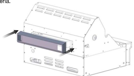
11. Vuelva a colocar los cuatro tornillos en la cubierta trasera del quemador rotisería.
