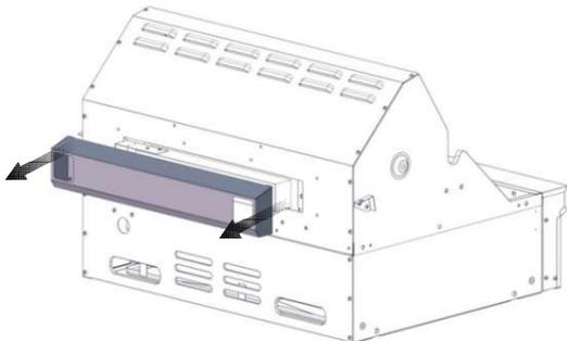
4. Retire los dos tornillos en el soporte de encendido y retire el soporte.
