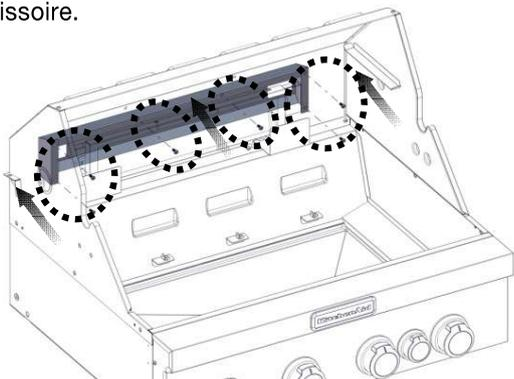
12. Réinstaller l'écran thermique du brûleur de la rôtissoire et serrer les deux vis.
