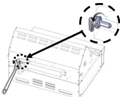
6. Retirer le gicleur à l'aide d'une clé à douille ou d'un tourne-écrou de 6 mm.
