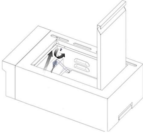
2. Retirer les deux vis à l'arrière du brûleur à infrarouge. Soulevez le brûleur à partir de l'arrière, comme illustré.
