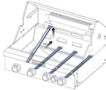
7. Si la llama está amarilla (no hay suficiente aire), gire hacia la izquierda el tornillo de ajuste del obturador de aire. Si la llama hace ruido o se separa del quemador (hay demasiado aire), gire hacia la derecha el tornillo de ajuste del obturador de aire.
