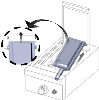
3. Utilice una llave de tubo de 6 mm o llave para tuercas de 6 mm para quitar el orificio.
