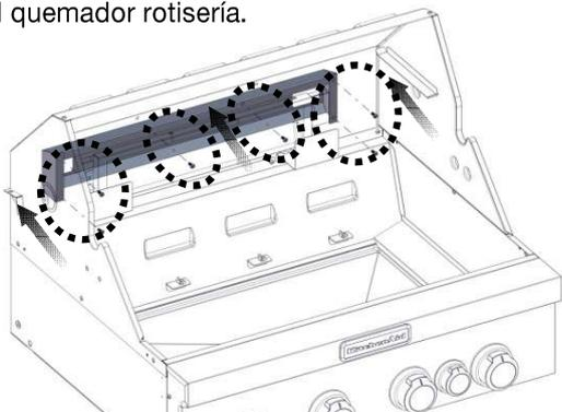
12. Vuelva a instalar el protector de calor del quemador rotisería y apriete los dos tornillos.
