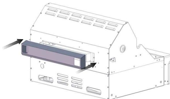
11. Serrer les quatre vis à l'avant du capot arrière de la rôtissoire.
