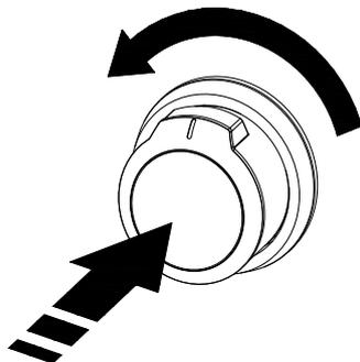
**IMPORTANTE:** Si el quemador no se enciende de inmediato, gire a perilla del quemador hacia “○” (Apagado) y espere 5 minutos antes de volver a encenderlo.
