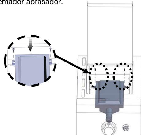
7. Use un destornillador para volver a instalar de la clavija del encendedor.
