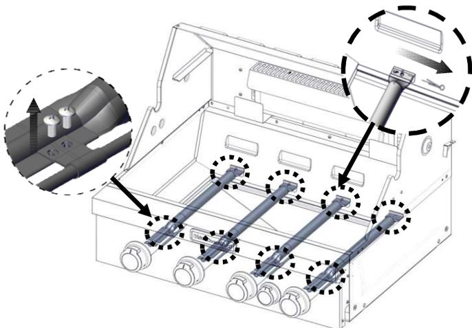
6. Desmontar el quemador de la parrilla levantando el quemador a cabo .
