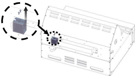
5. Utilice una llave ajustable para remover el codo de latón.
