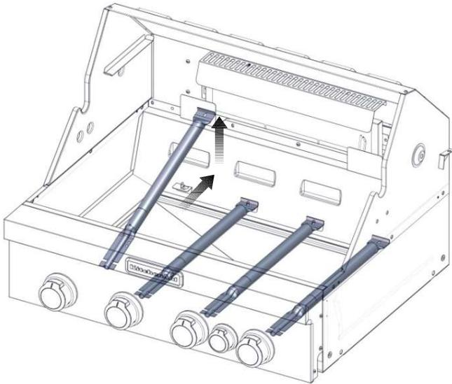
3. Inspeccione con una linterna el interior del quemador a través de la abertura, para cerciorarse de que no esté obstruido. Si se ve alguna obstrucción, use una percha de metal enderezada para desbloquearlo.
