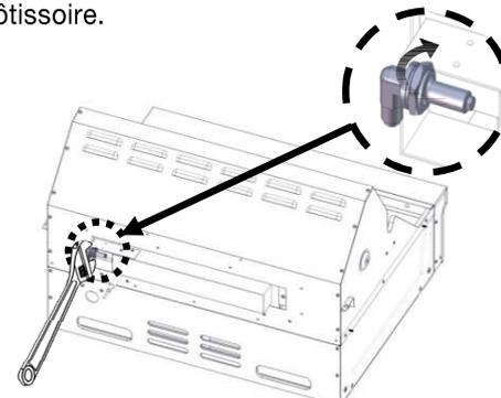
9. Réinstaller le support de l'électrode et serrer les vis.
