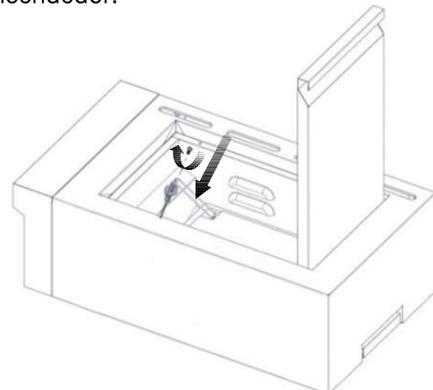
8. Abra la válvula de cierre manual de la línea de suministro de gas. La válvula está abierta cuando la manija está paralelo a la tubería de gas.
