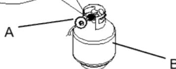
S'assurer que le dispositif de raccordement du robinet de la bouteille correspond au dispositif de raccordement fixé au point d'entrée du détendeur.
