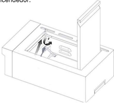
2. Retire los dos tornillos de la parte trasera del quemador abrasador. Levante el quemador a partir de la parte posterior.
