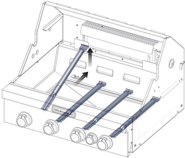
3. Utiliser une lampe de poche pour inspecter l'intérieur du brûleur par l'intermédiaire de l'entrée du brûleur pour vérifier qu'il n'y a pas de blocage. En cas d'obstruction, utiliser un cintre métallique redressé pour éliminer l'obstruction.
