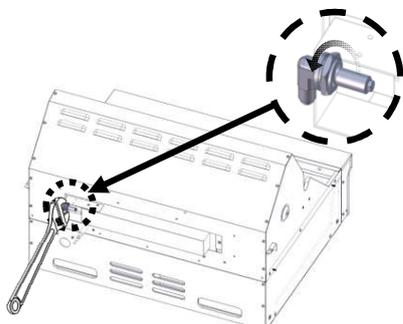
6. Utilice una llave de tubo de 6 mm o llave para tuercas de 6 mm para quitar el orificio.
