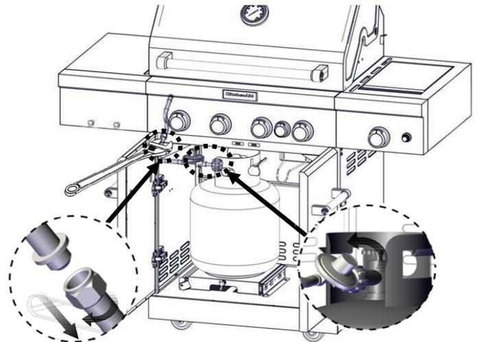
6. Utiliser une clé à molette pour installer le détendeur pour gaz naturel sur la tubulure de distribution et fixer. Fixer le détendeur pour gaz naturel au panneau latéral à l'intérieur du chariot du gril à l'aide des deux vis préassemblées sur le détendeur.
