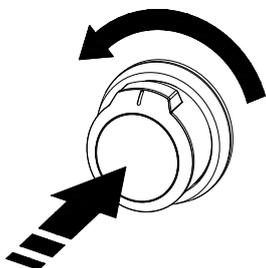
4. On doit pouvoir entendre le "crépitement" d'une étincelle. Lorsque le brûleur est allumé, lâcher le bouton. Tourner le bouton de commande au réglage désiré.
