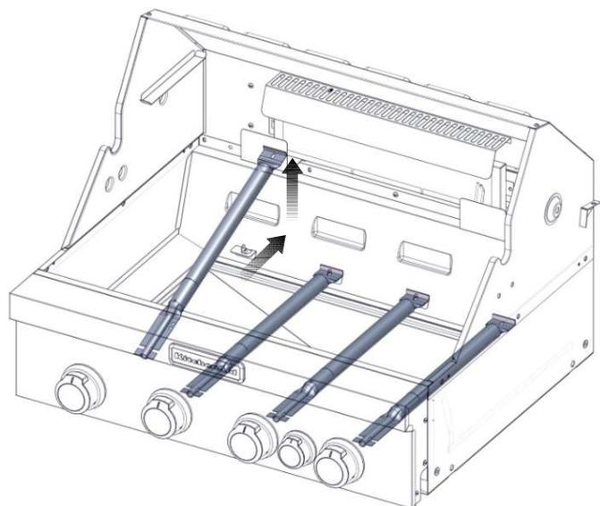
4. Démontez le gicleur en laiton de l'extrémité du robinet de gaz à l'aide d'une clé à douille de 6 mm ou d'un tourne-écrou de 6 mm. Le gicleur de brûleur principal se trouve derrière le gicleur pour gaz propane – aucun gicleur supplémentaire ne doit donc être installé.
