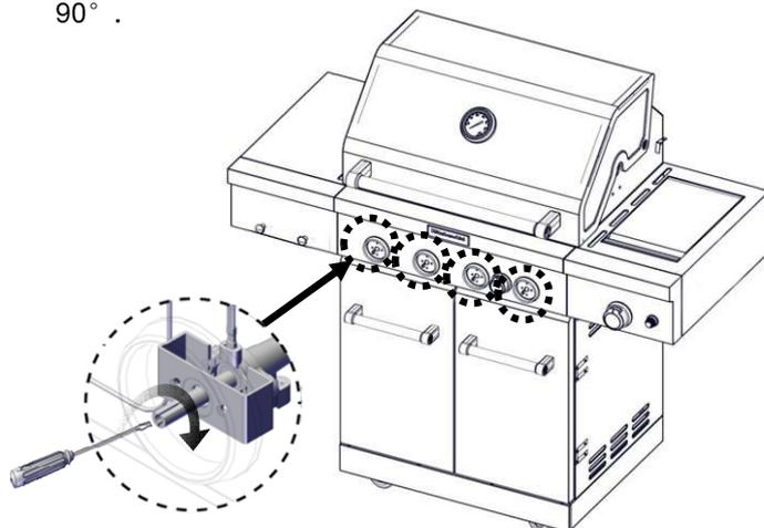
3. Verifique que el quemador funcione en el nuevo ajuste de llama alta. Tal vez sea necesario regular el ajuste del tornillo un poco más para obtener la altura ideal de la llama del quemador.
