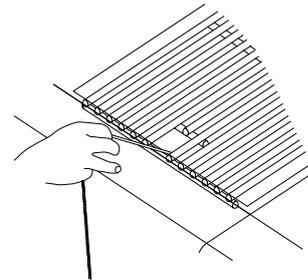
6. Empuje la perilla del quemador hacia dentro y gírela hacia "🔥" (Encender) para el quemador que esté más cerca del cerillo encendido. El quemador se encenderá inmediatamente. Cuando el quemador esté encendido, gire la perilla hacia el ajuste deseado.
