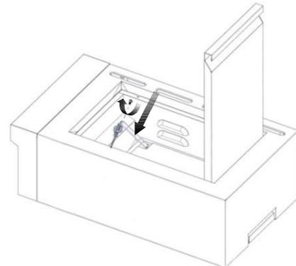
8. Ouvrir le robinet sur la canalisation d'alimentation en gaz. Le robinet est ouvert lorsque la poignée est parallèle au conduit d'alimentation en gaz.
