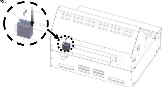
10. Vuelva a instalar la cubierta trasera del quemador rotisería.
