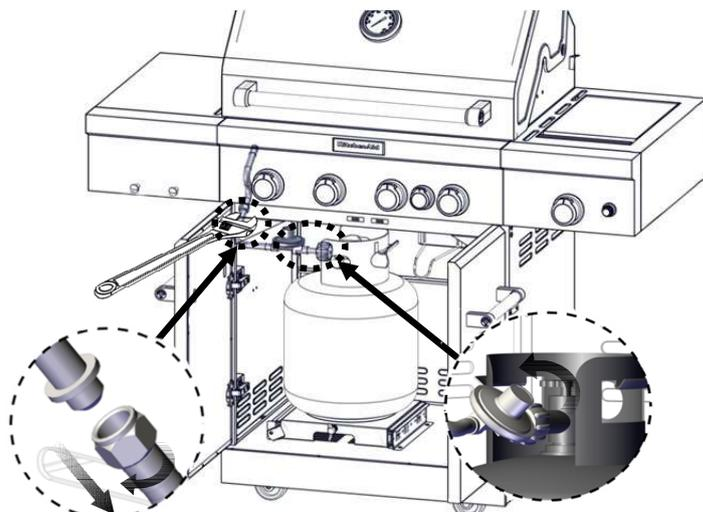
6. Use una llave de tuercas ajustable para instalar la manguera reguladora de gas natural al distribuidor y asegurarla. Sujete el regulador de gas natural al panel lateral, que está dentro del carro del asador, con los dos tornillos que están previamente ensamblados en el regulador.
