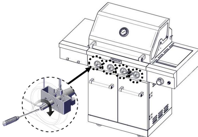
3. Vérifier que le brûleur fonctionne correctement avec le nouveau réglage de flamme haute. Il sera peut-être nécessaire d'ajuster légèrement le réglage de la vis pour obtenir la hauteur de flamme de brûleur idéale (1 pouce).
