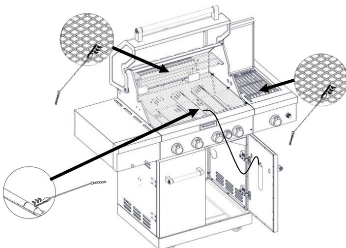
6. Pour le brûleur le plus proche de l'allumette allumée, enfoncer et faire tourner le bouton du brûleur à la position "●" (allumage). Le brûleur s'allume immédiatement. Lorsque le brûleur est allumé, tourner le bouton jusqu'au réglage désiré.
