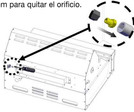
7. Sustituir por el orificio de gas natural correspondiente.
