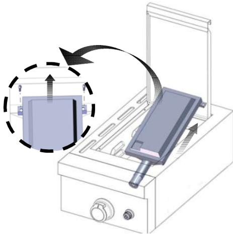
3. Démonter le gicleur à l'aide d'une clé à douille ou d'un tourne-écrou de 6 mm.
