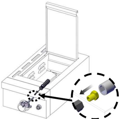
**IMPORTANTE:** Verifique que el orificio esté debidamente instalado dentro de la válvula.
