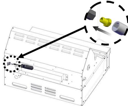
**IMPORTANTE:** Compruebe que el orificio de gas natural está instalado correctamente dentro de la válvula.
