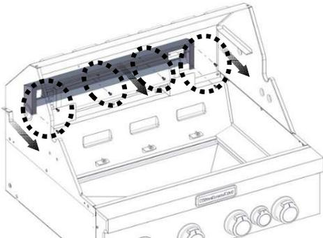
3. Retire la cubierta posterior del quemador rotisería.
