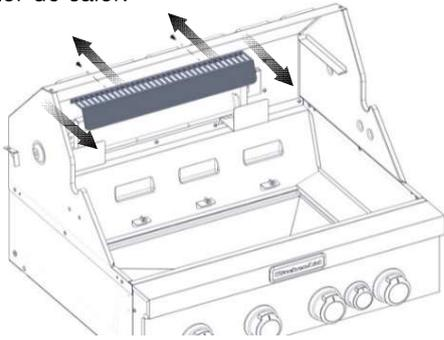
2. Retire los seis tornillos de la tapa trasera del rotisería.
