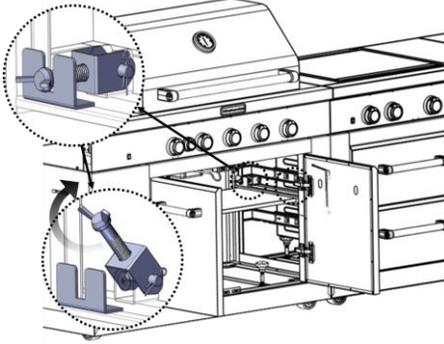
3. Utiliser un tournevis pour retirer la broche d'allumage. Retirer les deux vis à l'arrière du brûleur à infrarouge.
