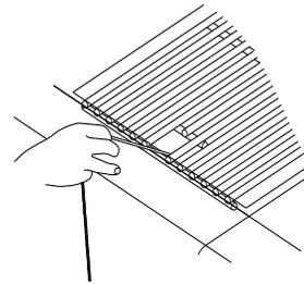
6. Empuje la perilla del quemador hacia dentro y gírela hacia "🔥" (Encender) para el quemador que esté más cerca del cerillo encendido. El quemador se encenderá inmediatamente. Cuando el quemador esté encendido, gire la perilla hacia el ajuste deseado.
