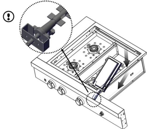
7. Vuelva a colocar los dos tornillos en la parte trasera del quemador abrasador. Use un destornillador para volver a instalar de la clavija del encendedor.
