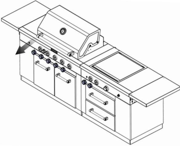
2. Use un destornillador de hoja plana para girar el tornillo opresor de llama alta hacia la izquierda aproximadamente 90°.
