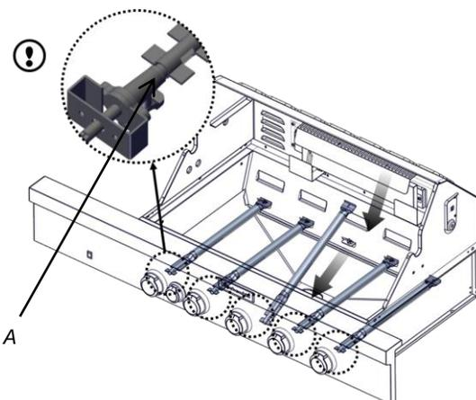
A. Conexión del quemador/orificio
