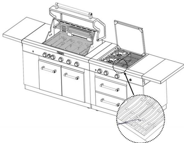
6. Empuje hacia dentro y gire la perilla del quemador hacia "●" (Encender) para el quemador que esté más cerca del cerillo encendido. El quemador se encenderá inmediatamente. Cuando el quemador esté encendido, gire la perilla hacia el ajuste deseado.
