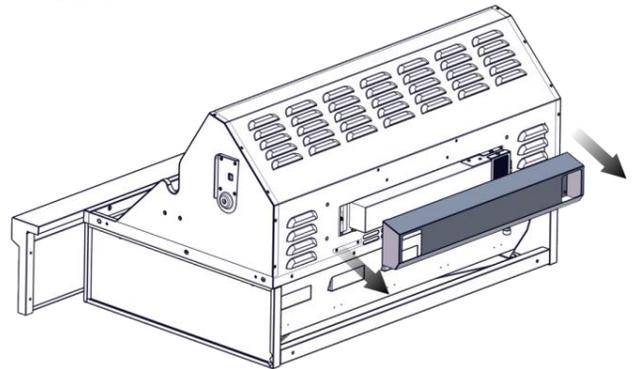
4. Retirer les deux vis du support de l'électrode pour retirer le support comme illustré.
