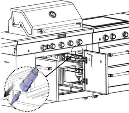
2. Libérer le mécanisme de verrouillage.
