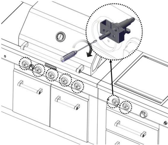
3. Verifique que el quemador funcione en el nuevo ajuste de llama alta. Tal vez sea necesario regular el ajuste del tornillo un poco más para obtener la altura ideal de la llama del quemador.
