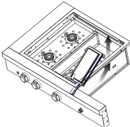
5. Démontez le gicleur à l'aide d'une clé à douille ou d'un tourne-écrou de 6 mm. Remplacer par le gicleur pour gaz naturel.
