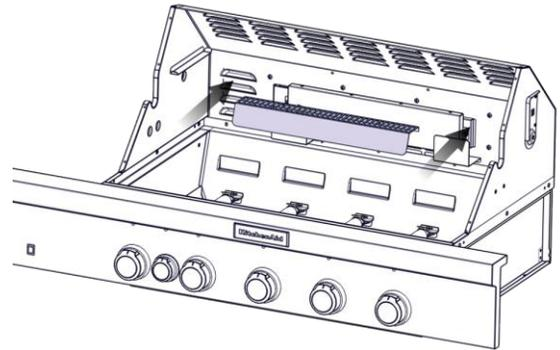
8. Réinstaller the support de l'électrode et serrer les vis.
