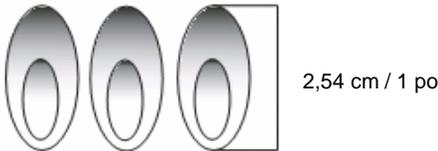
Vérifier que les brûleurs ne sont pas obstrués par de la poussière, des débris, nids d'insectes, etc.; nettoyer au besoin. Si les brûleurs sont propres, ajuster l'admission d'air au besoin.
