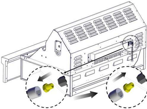
10. Serrer les six vis à l'avant du capot arrière de la rôtissoire.
