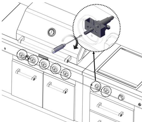
3. Vérifier que le brûleur fonctionne correctement avec le nouveau réglage de flamme haute. Il sera peut-être nécessaire d'ajuster légèrement le réglage de la vis pour obtenir la hauteur de flamme de brûleur idéale (1 pouce).
