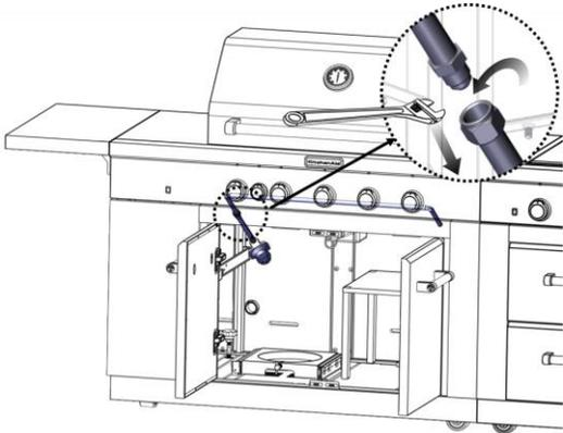
6. Use una llave de tuercas ajustable para instalar la manguera reguladora de gas natural al distribuidor y asegurarla. Sujete el regulador de gas natural al panel lateral, que está dentro del carro del asador, con los dos tornillos que están previamente ensamblados en el regulador.
