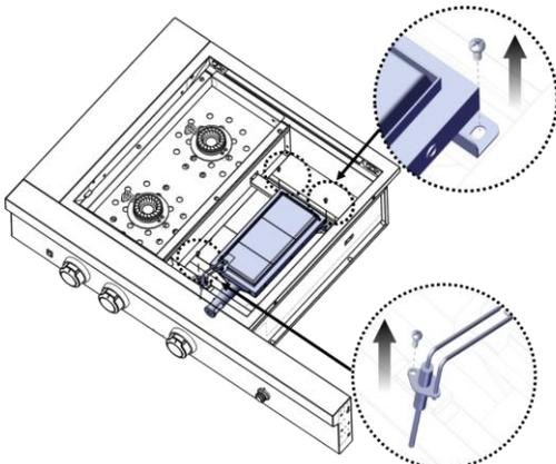
4. Levante el quemador a partir de la parte posterior.
