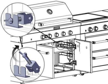
3. Utilice un destornillador para quitar el tornillo de la clavija del encendedor. Retire los dos tornillos de la parte trasera del quemador abrasador.
