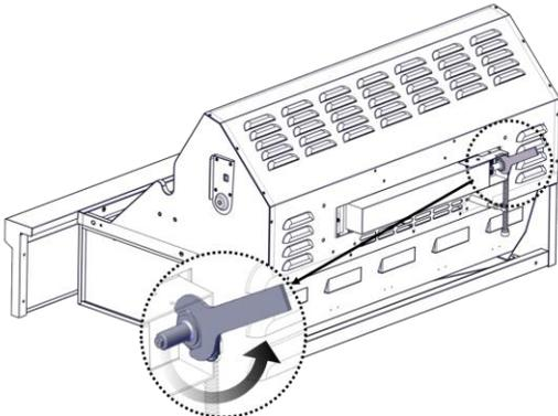
8. Vuelva a instalar el soporte del encendedor y apriete los tornillos.
