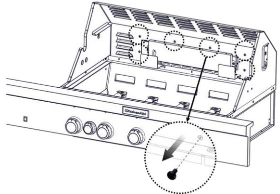
3. Retire la cubierta posterior del quemador rotisserie.
