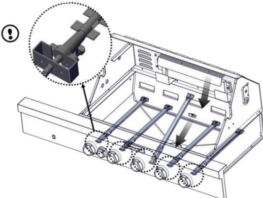
6. Coloque los equipos de encendido por lo que son de 3,2 mm / 1/8 in de cada quemador .
