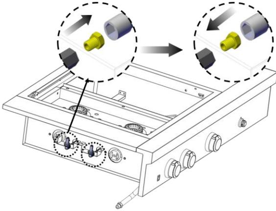
**IMPORTANTE:** Verifique que el orificio esté debidamente instalado dentro de la válvula.
