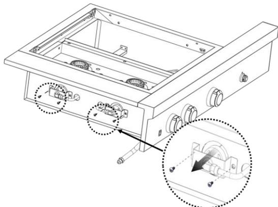
2. Démontez le gicleur à l'aide d'une clé à douille ou d'un tourne-écrou de 6 mm. Remplacez par le gicleur pour gaz naturel, pour chaque brûleur latéral.
