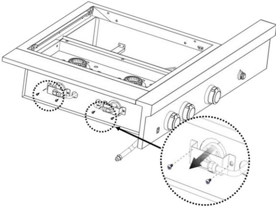
2. Utilice una llave de tubo de 6 mm o llave para tuercas de 6 mm para quitar el orificio. Reemplácelo con el orificio para gas natural.
