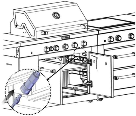
6. Abra la válvula de cierre manual de la línea de suministro de gas. La válvula está abierta cuando la manija está paralela al tubo de gas.
