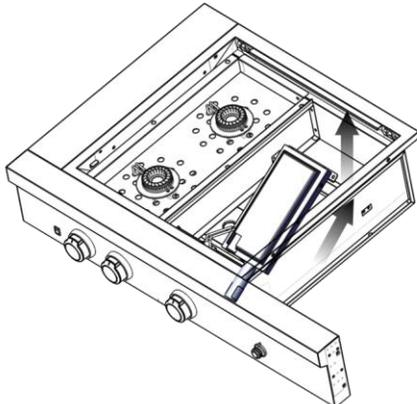
5. Utilice una llave de tubo de 6 mm o llave para tuercas de 6 mm para quitar el orificio. Reemplácelo con el orificio para gas natural.
