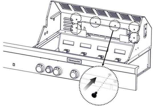
11. Vuelva a instalar el protector de calor del quemador rotisería.
