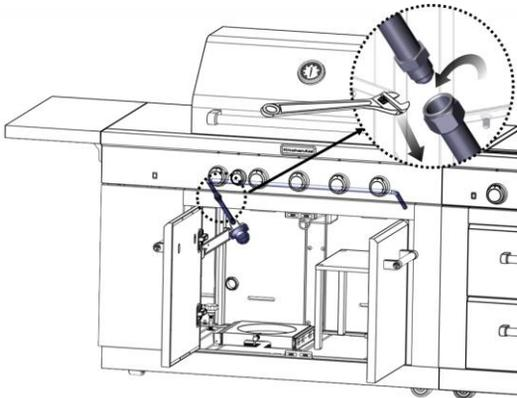
6. Utiliser une clé à molette pour installer le détendeur pour gaz naturel sur la tubulure de distribution et fixer. Fixer le détendeur pour gaz naturel au panneau latéral à l'intérieur du chariot du gril à l'aide des deux vis préassemblées sur le détendeur.
