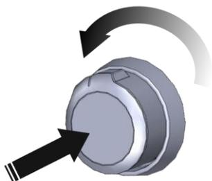
**IMPORTANTE:** Si el quemador no se enciende de inmediato, gire a perilla del quemador hacia “O” (Apagado) y espere 5 minutos antes de volver a encenderlo.
