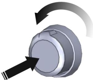
4. On doit pouvoir entendre le "crépitement" d'une étincelle. Lorsque le brûleur est allumé, lâcher le bouton. Tourner le bouton de commande au réglage désiré.
