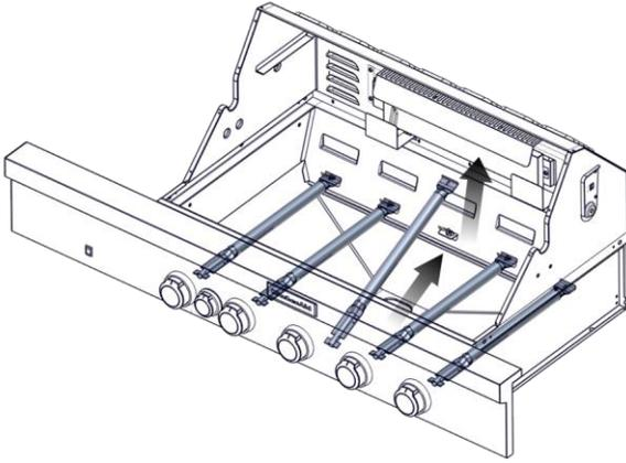
4. Démontez le gicleur en laiton de l'extrémité du robinet de gaz à l'aide d'une clé à douille de 6 mm ou d'un tourne-écrou de 6 mm. Le gicleur de brûleur principal se trouve derrière le gicleur pour gaz propane – aucun gicleur supplémentaire ne doit donc être installé.
