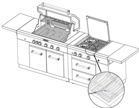
6. Pour le brûleur le plus proche de l'allumette allumée, enfoncer et faire tourner le bouton du brûleur à la position "●" (allumage). Le brûleur s'allume immédiatement. Lorsque le brûleur est allumé, tourner le bouton jusqu'au réglage désiré.
