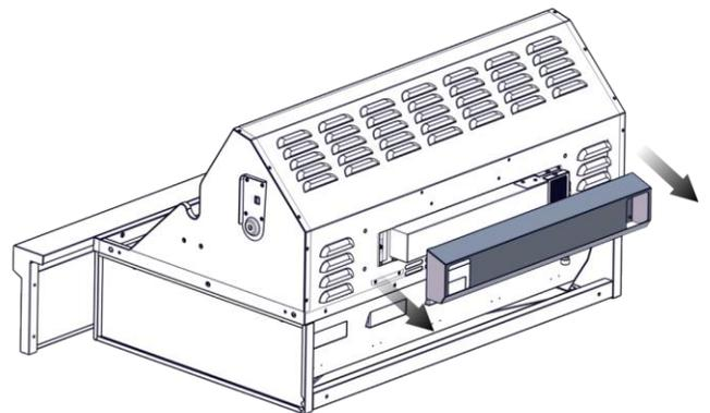
4. Retire los dos tornillos en el soporte de encendido y retire el soporte.
