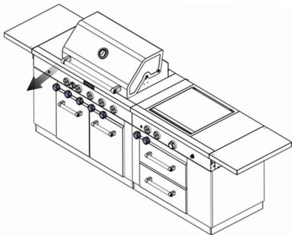
2. Utiliser un tournevis à lame plate pour tourner la vis de réglage de flamme haute dans le sens inverse des aiguilles d'une montre d'environ 90°.
