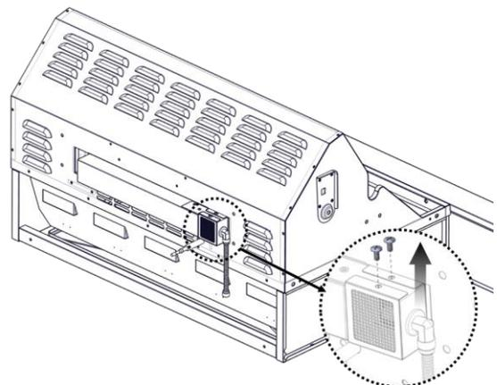
5. Utilice una llave ajustable para remover el codo de latón.
