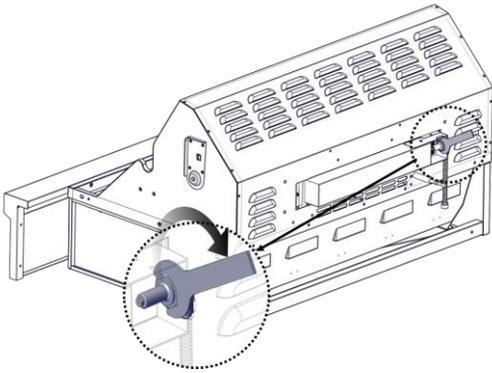
6. Utilice una llave de tubo de 6 mm o llave para tuercas de 6 mm para quitar el orificio. Sustituir por el orificio de gas natural correspondiente.
