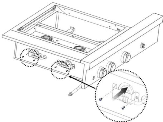
4. Remplacer le mécanisme de verrouillage en position verrouillée.
