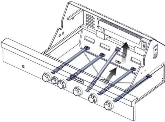
3. Inspeccione con una linterna el interior del quemador a través de la abertura, para cerciorarse de que no esté obstruido. Si se ve alguna obstrucción, use una percha de metal enderezada para desbloquearlo.
