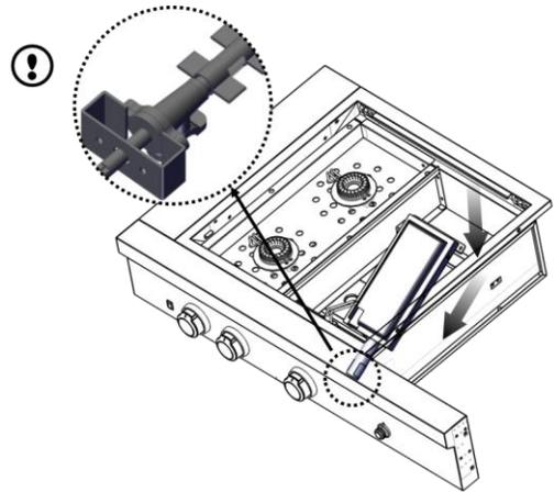
7. Réinstaller les deux vis à l'arrière du brûleur à infrarouge. Utiliser un tournevis pour réinstaller la broche d'allumage.
