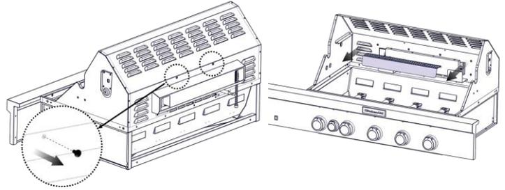
2. Retire los seis tornillos de la tapa trasera del rotisserie.
