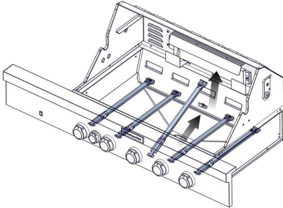
4. Use un casquillo y una llave de cubo de 6 mm o un aprietatuercas de 6 mm para quitar el orificio de bronce del extremo de la válvula de gas. El orificio del quemador principal está ubicado detrás del orificio de gas LP, de manera que no necesita instalar un orificio adicional.
