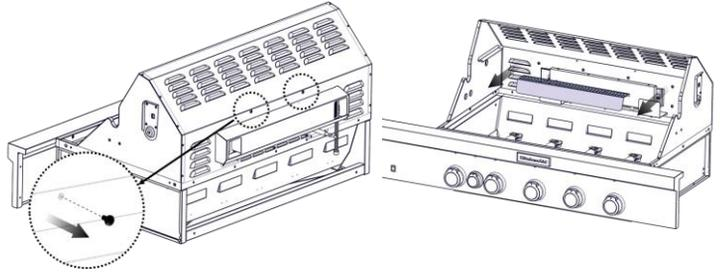
2. Retirer les six vis du capot arrière du brûleur de la rôtiissoire.
