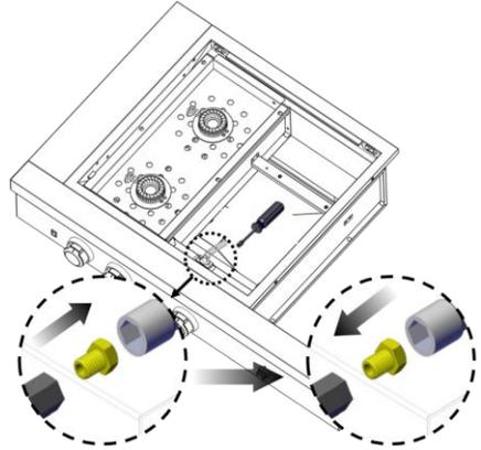
**IMPORTANTE:** Verifique que el orificio esté debidamente instalado dentro de la válvula.
