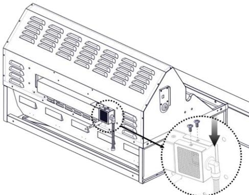
9. Vuelva a instalar la cubierta trasera del quemador rotisería.
