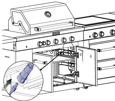
6. Ouvrir le robinet d'arrêt manuel sur la canalisation d'alimentation en gaz. Le robinet est ouvert lorsque la poignée est parallèle au conduit d'alimentation en gaz.
