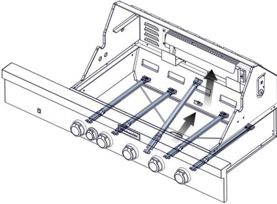
3. Utiliser une lampe de poche pour inspecter l'intérieur du brûleur par l'intermédiaire de l'entrée du brûleur pour vérifier qu'il n'y a pas de blocage. En cas d'obstruction, utiliser un cintre métallique redressé pour éliminer l'obstruction.
